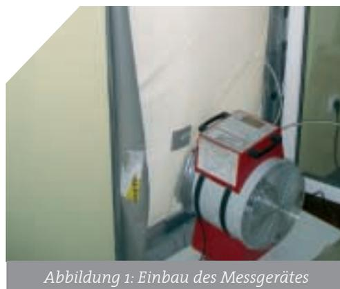
Abbildung 1: Einbau des Messgerätes
